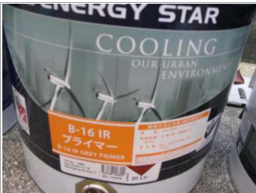
屋根下塗り使用材料
